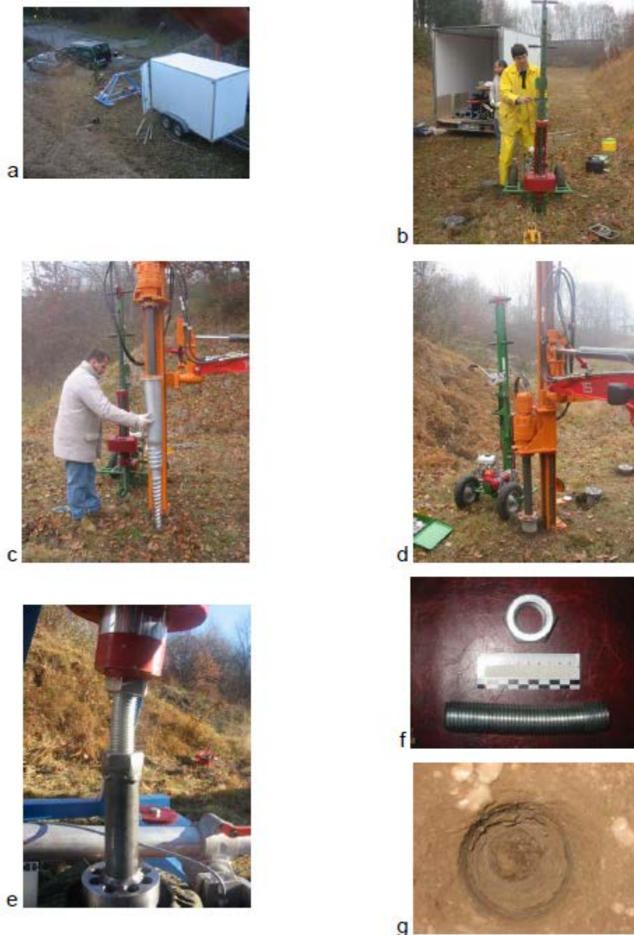
Рисунок А9-5: испытания на территории «бывшего тира» UniMwM в Нойбиберге, подъезд к тиру, (участок «UNiSd»): вид с северо-востока (a), с юга (b с тяжелым динамическим зондированием), вращение фундаментного винта (c,d), при испытании давлением нарезной штифт испытательного прибора (e,f), и вид в отверстие вывинчиваемого фундаментного винта (g).
