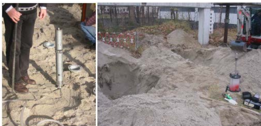
Рисунок А3-33 е до f: легкое динамическое зондирование (DPL) и шурфы 1 и 2.
