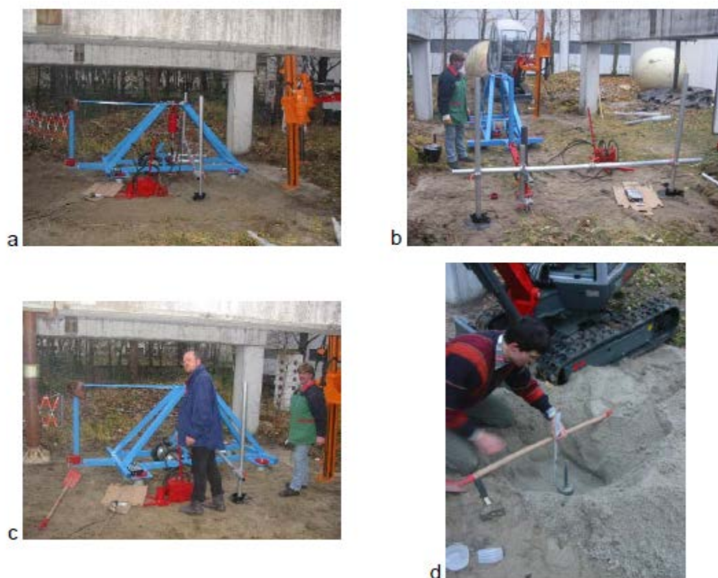
Рисунок А9-1: а) до д) испытания на открытой территории UniMwM в городе Нойбиберг между расположенными там бетонными балками (участок «UNiF»): вид с юга (а), с запада (b), во время испытания фундаментных винтов в центрическом направлении (с), определение плотности в сухом виде с вставным цилиндром и тензиметром (d).
