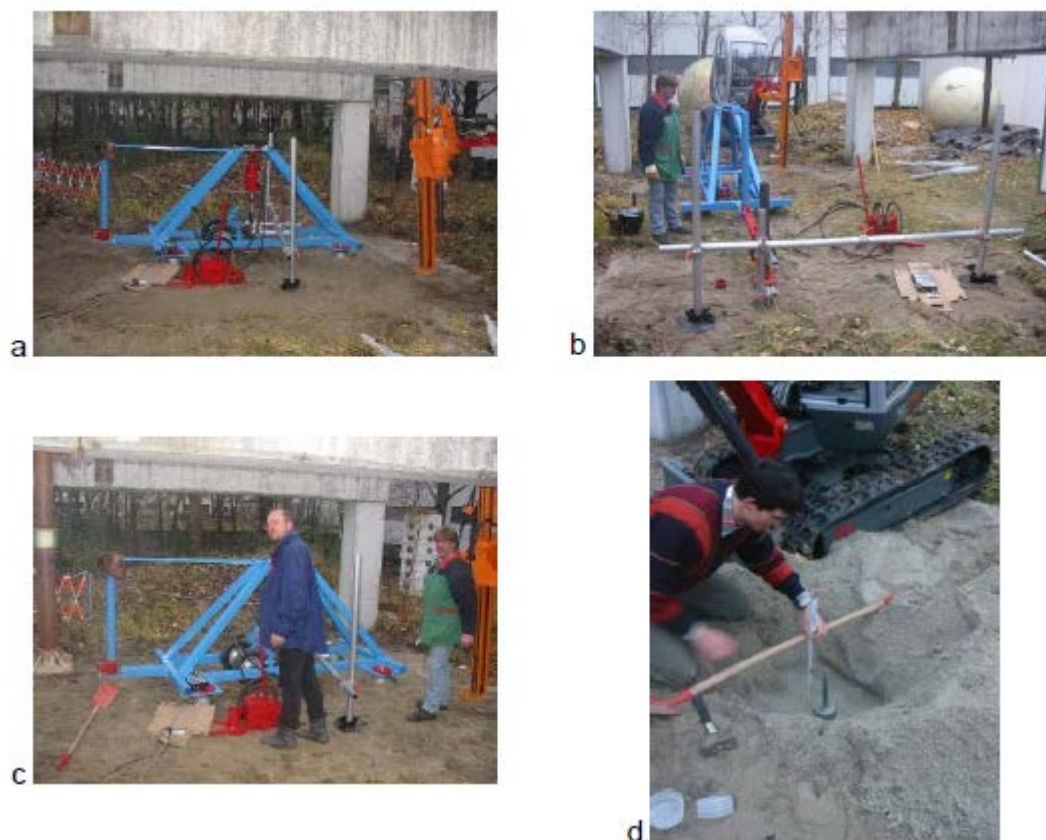
A9-1-сурет: а) дейін d) Нойбиберг қаласындағы сонда орнатылған бетон арқалықтары арасындағы UniMwM ашық алаңдағы сынақтар («UNI» учаскесі): оңтүстік жақтағы көрініс (а), батыс жақтан(б), сынақ барысында іргетабан бұрандалары орталық бағытта болды(с), тығыздық құрғақ күйде салмалы цилиндр және тензиметрмен (d) анықталды.
