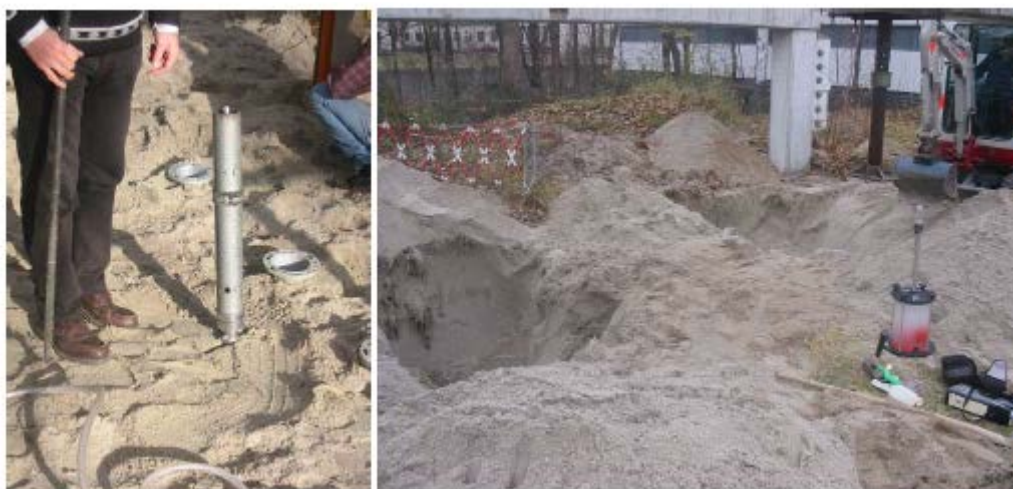
A3-33 е –ден f- дейінгі сурет: Жеңіл динамикалық зондылау (DPL) және 1, 2 шурфтар.
