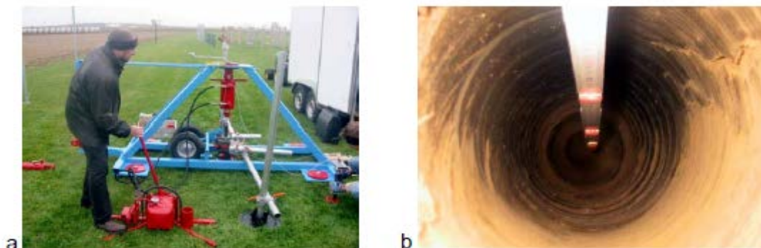
A9-3-сурет: а) Штрасскирхен қаласындағы Krinner фирмасының аумағындағы сынақтар („Kri“ учаскесі); б) іргетабан бұрандаларын демонтаждау кейінгі тұрақты қуыс кеңістік көрінісі.
