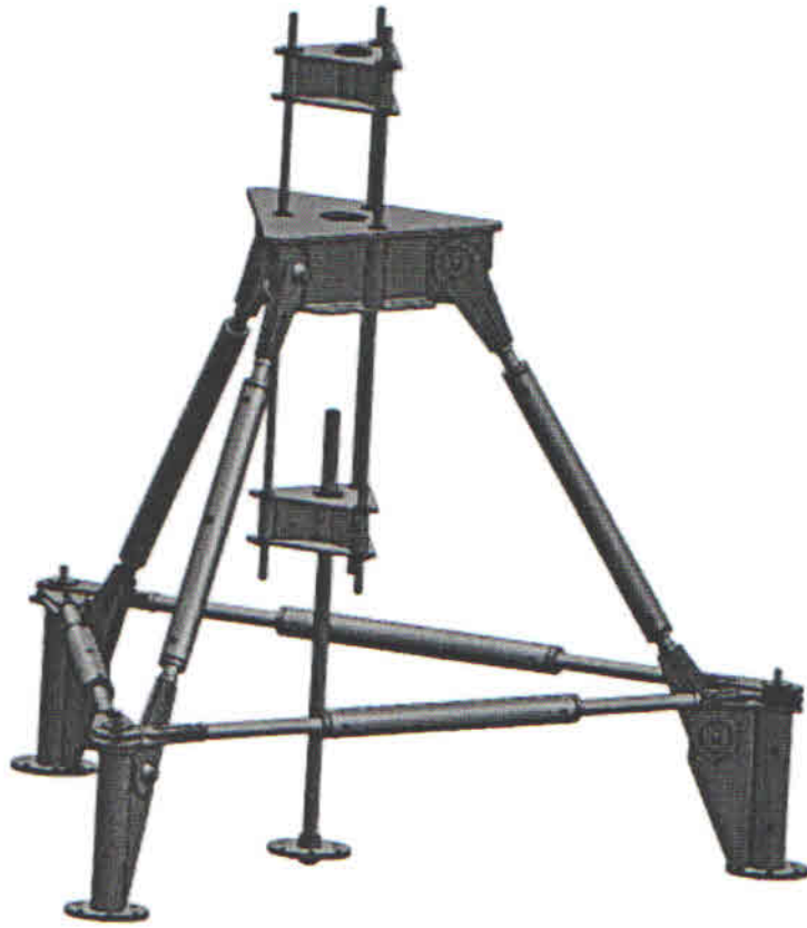
Рисунок 4- Схема станда (УУ-ВСК ) для испытания на выдергивание
