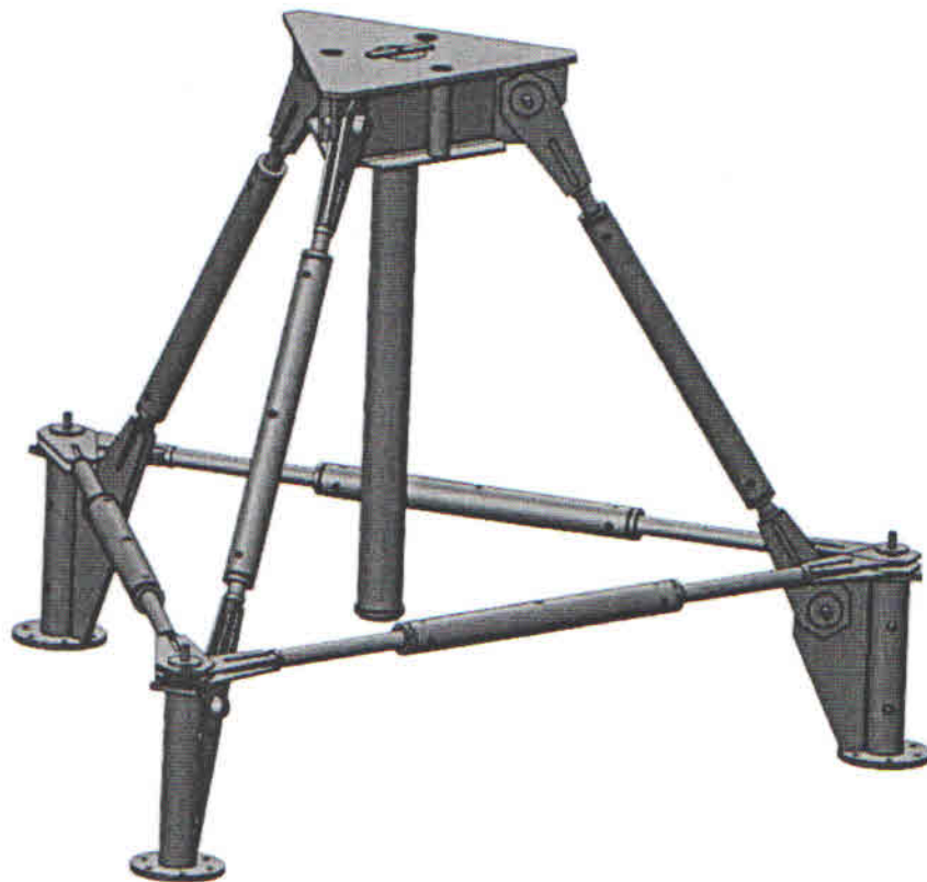
Рисунок 3- Схема станда (УУ-ВСК ) для испытания на вдавливание
