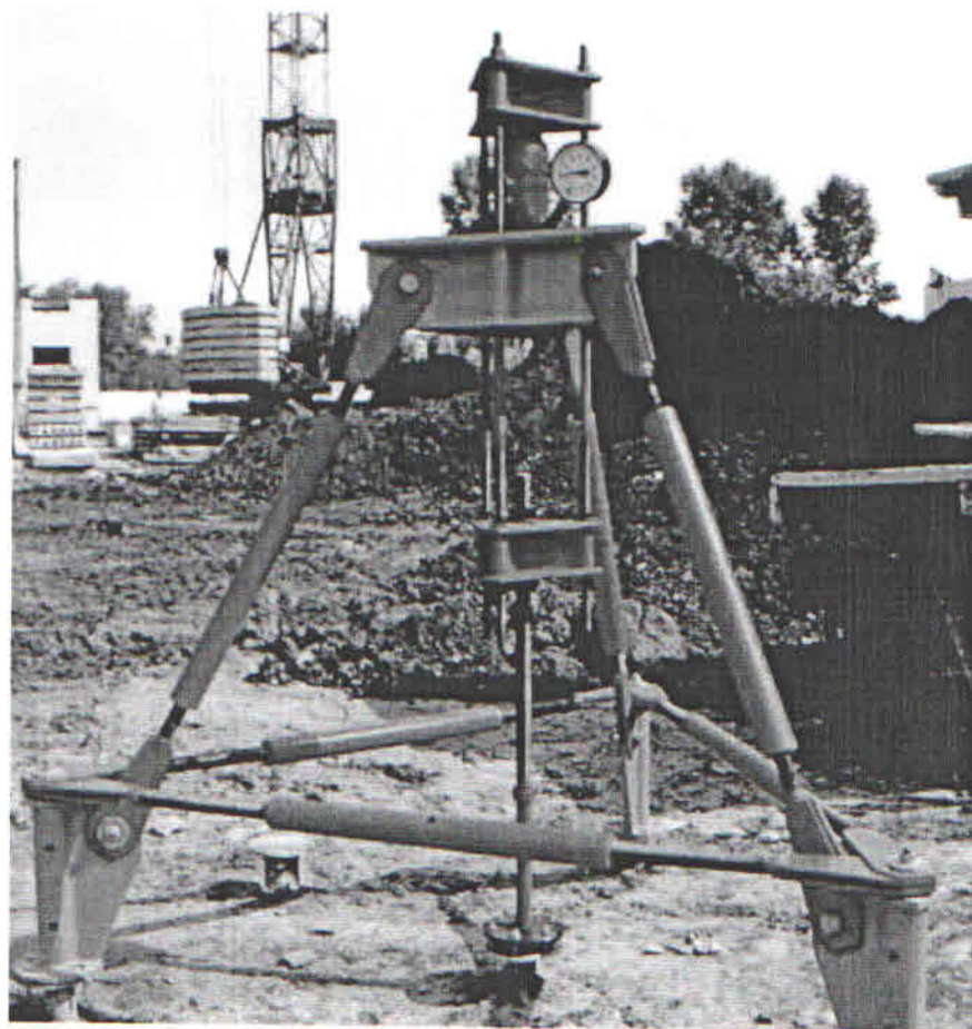
Фото 4- Стенд УУ-ВСК в полевых условиях (испытания на выдергивание)
