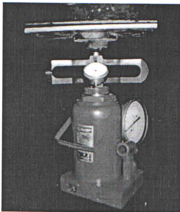
Фото 6- Тарировка домкрата на прессовом оборудовании с использованием образцового динамометра и манометра
