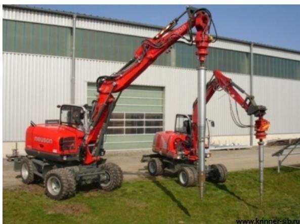
Рисунок 3 – Сваепогружающие механизмы
