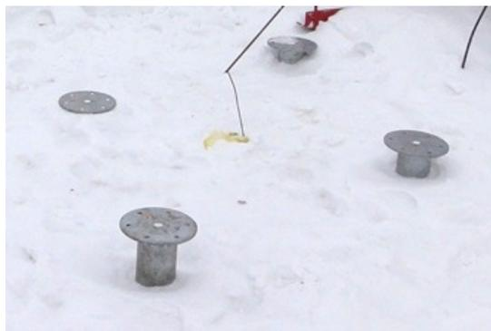
Рисунок 7 – Винтовые сваи «КРИННЕР» на экспериментальной площадке
