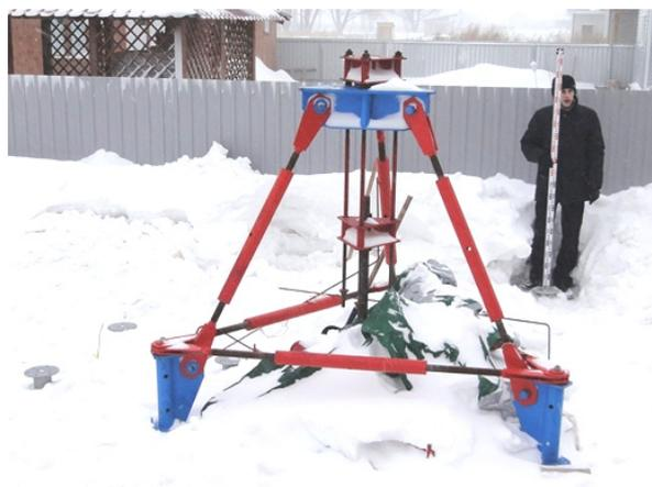
Рисунок 8 – Снятие вертикальных перемещений винтовых свай «КРИННЕР» от воздействий сил морозного пучения
